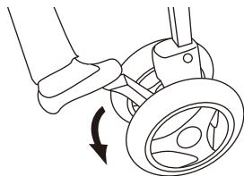
① 制動：踩住後輪煞車踏板，後輪即處於煞車狀態；腳尖將煞車踏板向上提，煞車將鬆開。
