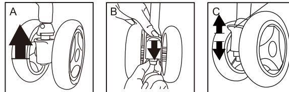
2. 安裝前輪：將前輪插入前輪支架上，聽到“喀喀”聲後即表示安裝完成。
