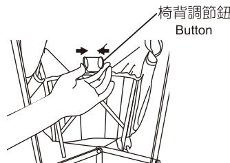
④ 調整椅背：按住椅背調節鈕，椅背可上下進行調整，可四段調整。
