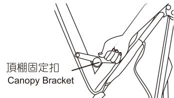
② 頂棚：頂棚固定扣向下壓，頂棚即可打開，向上提，頂棚將收攏。
