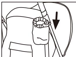
5. 安裝杯架：對準卡筍向下壓後即安裝完成。向上拉起即可拆卸。
