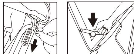
3. 安裝頂棚：將頂棚固定扣插入兩側卡筭位置，聽到“喀”聲後即可，拉開頂棚前端，下壓左右外側的頂棚固定扣，頂棚即可張開。收合頂棚固定扣，即可收起頂棚。
