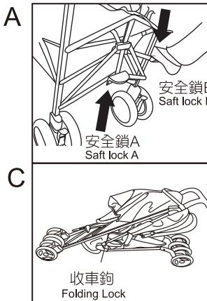
A-用腳尖將安全鎖A向上提，再踩下安全鎖B，直到二道鎖處於鬆弛狀態。
